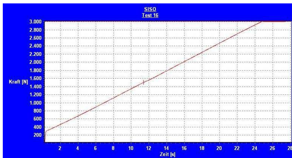
Fig. 21: static load test - for example model „SQUARE“ 22.10.200-0
